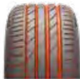
Profil mit variablen Längsrillen
