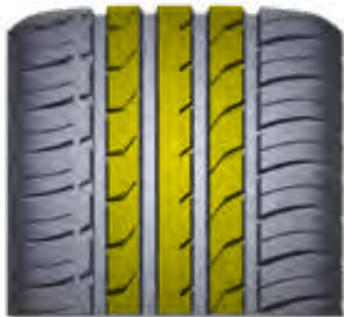
Multi-Zwischenraum-Profil mit reduziertem Rollwiderstand für deutliche Geräuschminimierung.
